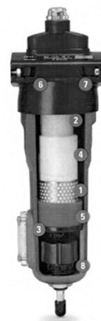
Rys. 1 Budowa typowego filtra sprężonego powietrza 1 – wzmocniona stal, 2 – zabezpieczenie papierowe, 3 – epoksydowe nakładki uszczelniające, 4 – wzmocnione włókno szklane, 5 – podwójna warstwa drenażowa złożona z warstwy papierowej i warstwy pianki poliuretanowej, 6 – podwójne pierścienie uszczelniające, 7 – odprowadzenie oczyszczonego powietrza, 8 – spust kondensatu. [AtlasCopco, 2015]
