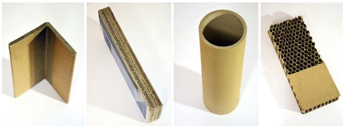
Rys. 1. Wybrane rodzaje materiałów celulozowych – kształtka tekturowa, tektura falista, tuleja papierowa i płyta o strukturze plastra miodu [1]
