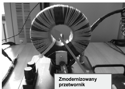
Rys. 3. Licznik wzorcowy RD-22 po modernizacji Fig. 3. RD-22 standard electricity meter after modernization
