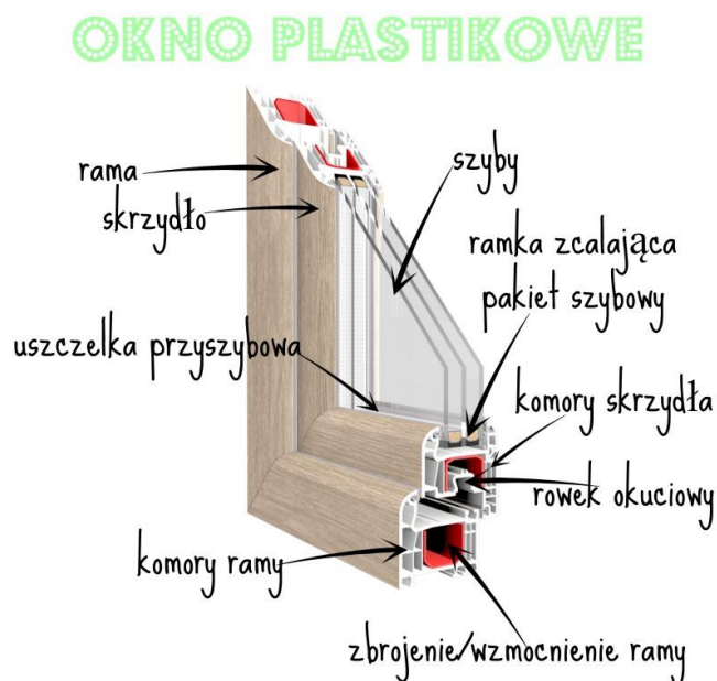
Rys. 1. Elementy składowe okien wykonanych z profili PCV
