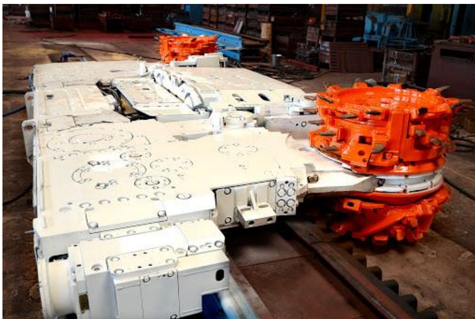
Rys. 2 Niski, portalowy kombajn KA200 z częścią kadłuba pomiędzy przenośnikiem i sekcjami obudowy zmechanizowanej
