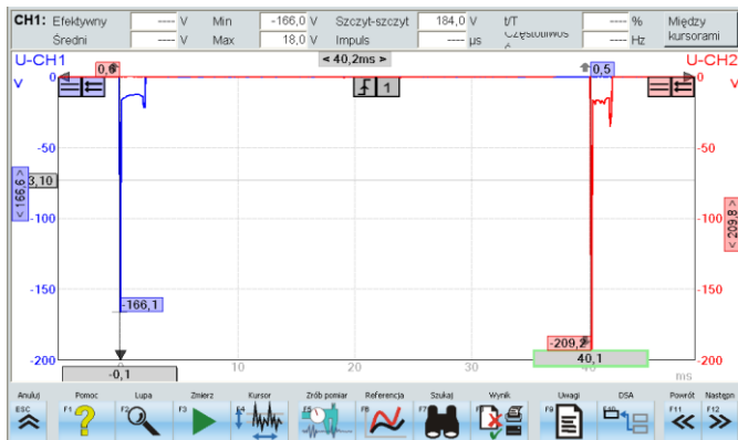
Rys. 2. Pomiar napięcia samoindukcji obwodów pierwotnych dwuiskrowej cewki zapłonowej (Dacia Logan MCV 1.6); U-CH1 – kanał pomiaru napięcia samoindukcji cewki zapłonowej inicjującej zapłon na cylindrach 1 i 4 (wartość poprawna), U-CH2 – kanał pomiaru napięcia samoindukcji cewki zapłonowej inicjującej zapłon na cylindrach 2 i 3 (brak wymaganego luzu na zaworze wylotowym cylindra nr 3)
