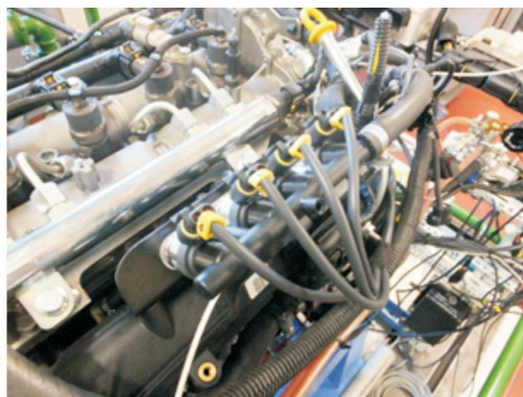
Fig. 1. Intake manifold of the Fiat 1.3 MJT engine with the gas injectors: a) before fitting, b) fitted in the engine Rys. 1. Kolektor dolotowy silnika Fiat 1.3 MJT z wtryskiwaczami gazu: a) kolektor przed montażem, b) kolektor po zamontowaniu
