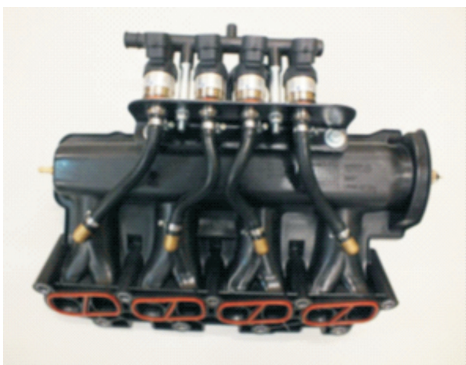
Fig. 1. Intake manifold of the Fiat 1.3 MJT engine with the gas injectors: a) before fitting, b) fitted in the engine Rys. 1. Kolektor dolotowy silnika Fiat 1.3 MJT z wtryskiwaczami gazu: a) kolektor przed montażem, b) kolektor po zamontowaniu
