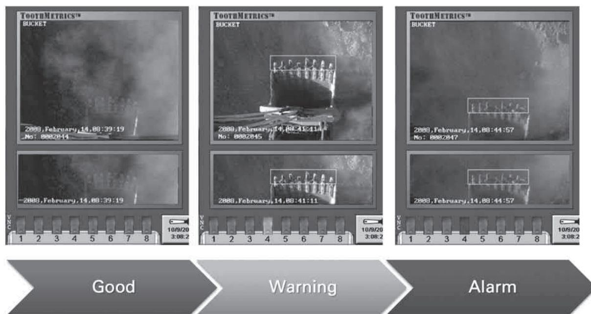
Rys. 5 Przykładowe widoki z kamery narzędzia ToothMetrics® z trzema stanami pracy zębów koparki [5] Fig. 5. Example of ToothMetrics® system camera views which show three operating status of shovel teeth
