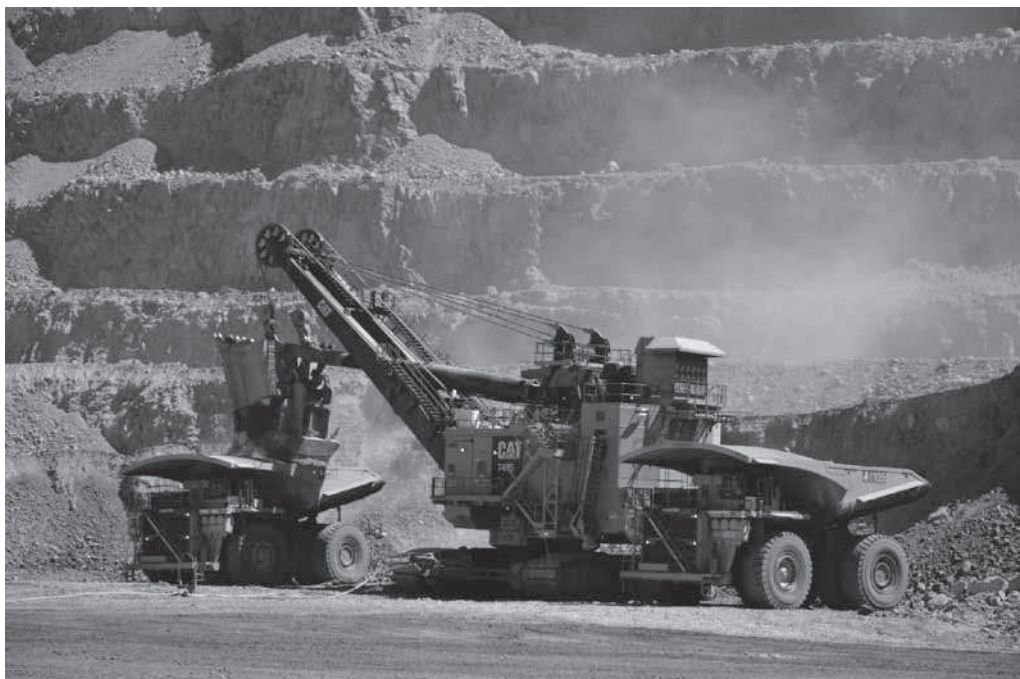
Rys. 1. Koparka CAT7495 oraz wozidła Komatsu 930E-4 w kopalni Sierra Gorda [fot.: Z. Kasztelewicz]
