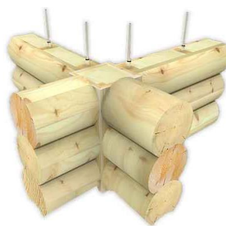
Rys. 7. Narożnik z M-Bali okrągłych dwustronnych z pełnymi ostatkami [2]
