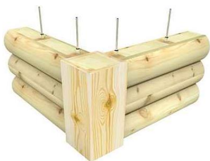
Rys. 6. Narożnik z M-Bali okrągłych dwustronnych bez ostatków [2]
