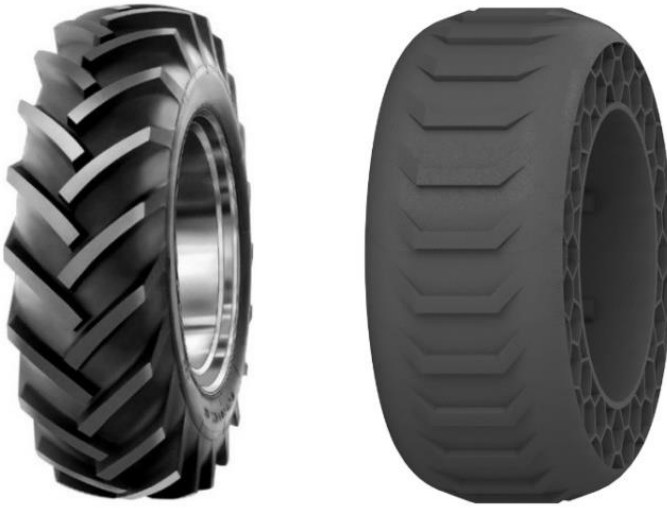
Rys. 3. Porównanie opon z bieżnikiem komercyjnym i zaproponowanym w ramach projektu [3]
