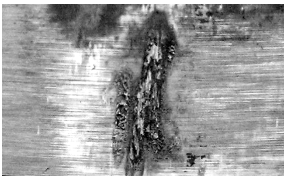
Rys. 4. Krater i małe wżery na powierzchni wewnętrznej pierścienia wewnętrznego
