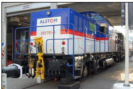
Rys. 3. Hybrydowa lokomotywa spalinowa BR 203H firmy Alstom [6]
