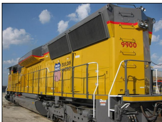
Rys. 5. Zmodernizowana lokomotywa SD59MX wyposażona w zestaw 9 układów DOC + DPF [8]
