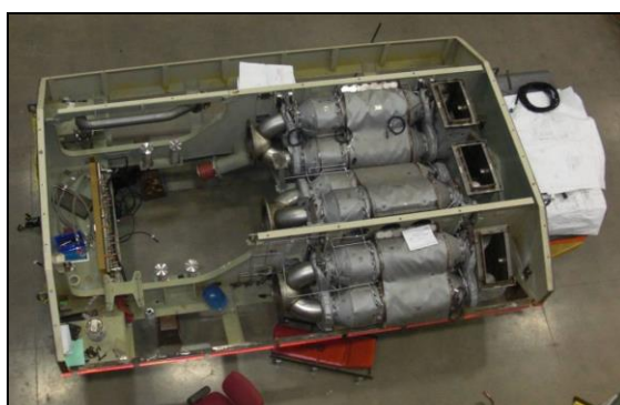
Rys. 4. Układ oczyszczania spalin przed montażem w lokomotywie [8]
