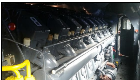
Rys. 1. Silnik 2-5D49 lokomotywy BR232 z 1976 r. poddany naprawie głównej
