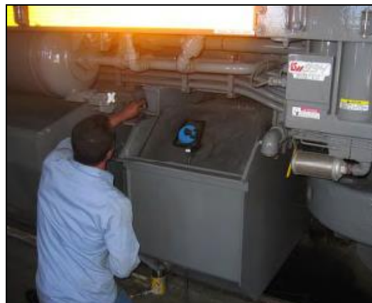
Rys. 6. Zamontowany na lokomotywie zbiornik z płynem AdBlue [8]
