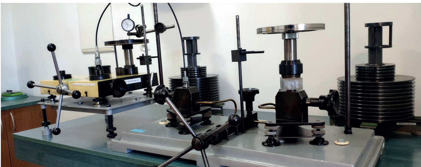
Rys. 2. Stanowisko do wzorcowania ciśnieniomierzy obciążnikowo-tłokowych
