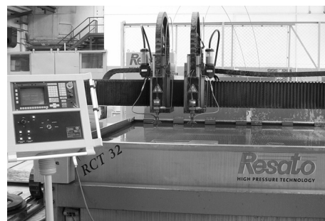
Rys. 2. Centrum obróbkowe AWJ typ RCT 32
