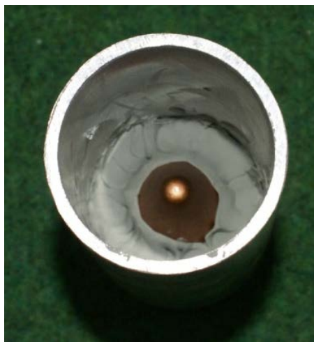
Rys. 9. Ładunek kumulacyjny częściowo wypełniony plasteliną
