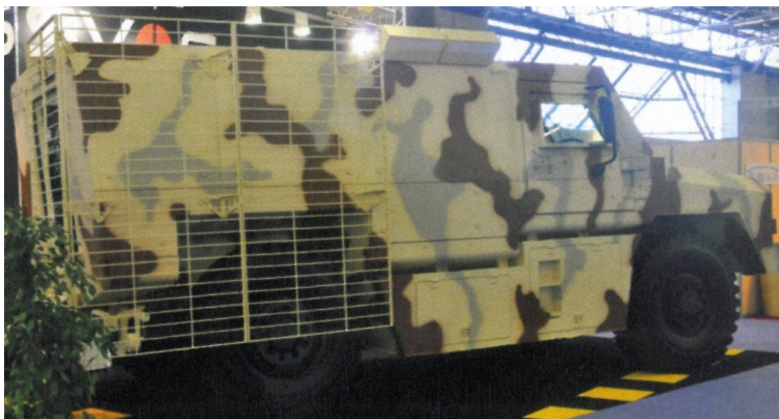
Rys. 1. Demonstrator pojazdu klasy MRAP z pancerzem prętowym [1]
