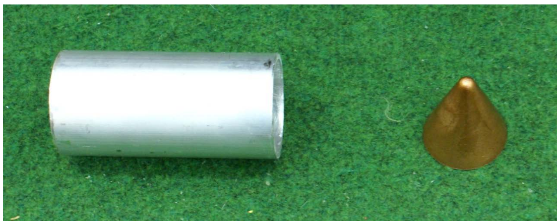
Rys. 7. Elementy składowe ładunku kumulacyjnego
