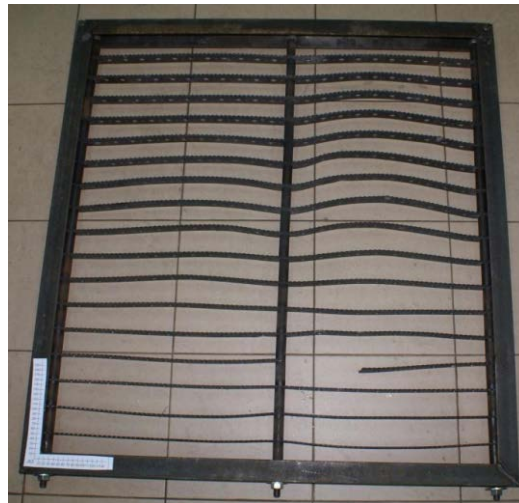
Rys. 3. Widok ramki z pancerzem prętowym po uderzeniu pocisku z głowicą kumulacyjną [6]
