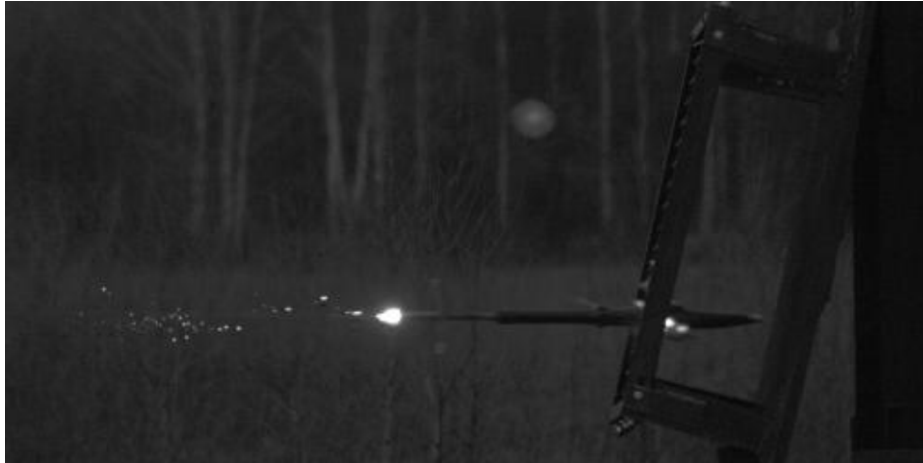
Rys. 2. Przejście głowicowej części pocisku do RPG 7 pomiędzy elementami pancerza prętowego [6]
