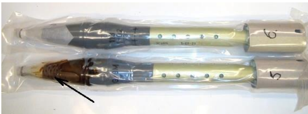
Fot. 6. Olej trotylowy na powierzchni pocisku OG-9 zapakowanego w hermetyczne opakowanie foliowe Photograph 6. Trotyl oil on the surface of OG-9 projectile within a sealed foil
