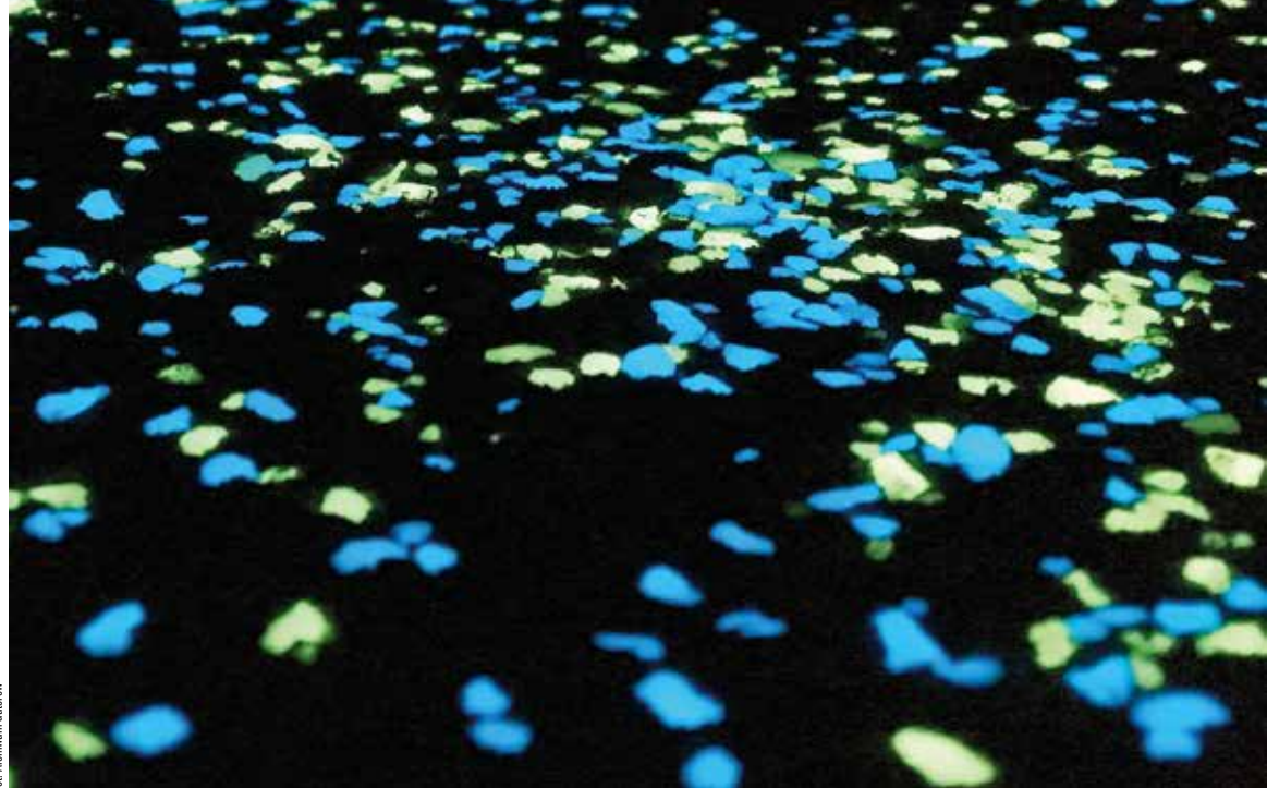
Rysunek 1. Beton z eksponowanym kruszywem fotoluminescencyjnym
