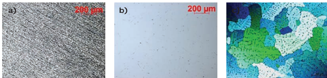
Rys. 4. Kolejne etapy polerowania i trawienia: a) diament 5 mm – tarcza z włókna octanowego; b) tlenek krzemu 0,04 mm – tarcza z kauczuku neoprenowego; c) trawienie
