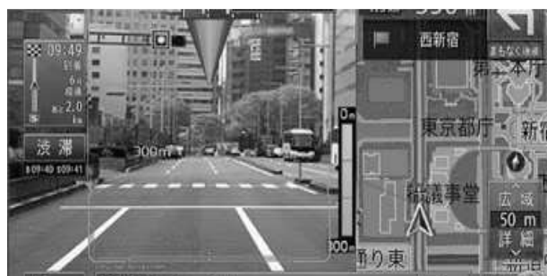
Rys.10. Przykładowy wygląd ekranu samochodowej nawigacji GPS wykorzystującej techniki rozszerzonej rzeczywistości (źródło: [17])
