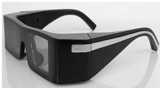
Rys. 5. Przykładowy model HMD typu optical see-through (źródło: [9])
