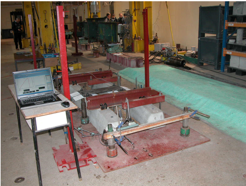
Rys. 2. Widok badanego układu z dwoma podkładami i sztabą wzmacniającą
