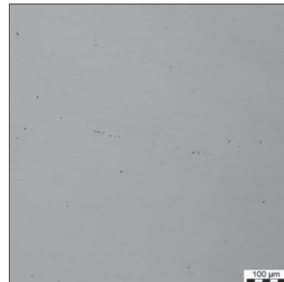
Rys. 4. Przykładowa fotografia wtrąceń niemetalicznych w stali C5-1 na przekroju wzdłużnym pręta \phi 18 mm Fig. 4. An example of a photograph of non-metallic inclusions in the C5-1 steel on the longitudinal section of the \phi 18 mm rod
