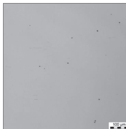
Rys. 2. Przykładowe wtrącenia niemetaliczne w stali B3 na przekroju wzdłużnym płaskownika o grubości 3 mm
