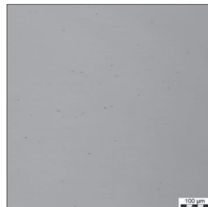
Rys. 7. Przykładowe fotografie wtrąceń niemetalicznych w stali C5-2 na przekroju wzdłużnym walcowanej na gorąco próbki o grubości 5 mm
