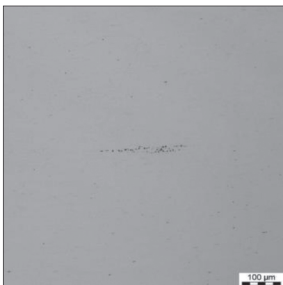
Rys. 7. Przykładowe fotografie wtrąceń niemetalicznych w stali C5-2 na przekroju wzdłużnym walcowanej na gorąco próbki o grubości 5 mm
