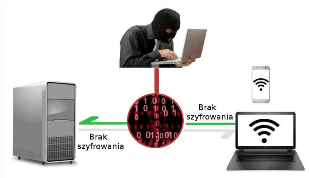
Rys. 2. Zobrazowanie użycia sniffera w otwartym WiFi.
