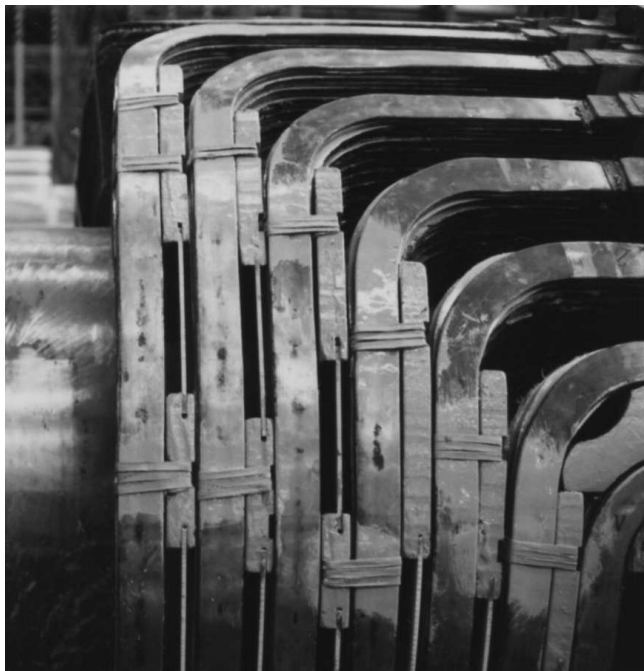
Rys. 1. Widok czołowy fabrycznego uzwojenia wzbudzenia generatora
