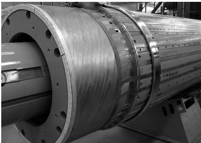
Rys. 4. Nowa klatka tłumiąca w wirniku generatora
