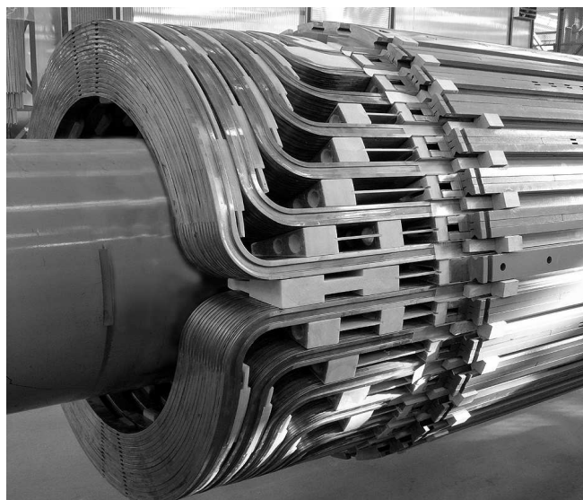
Rys. 3. Odkuwka wirnika generatora z nowym uzwojeniem wzbudzenia
