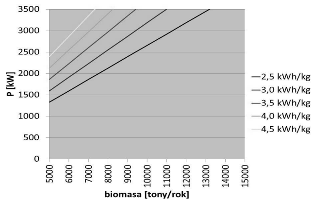
Rys. 9. Osiągana moc cieplna kotła w funkcji ilości spalanej biomasy (dla różnych wartości opałowych)
