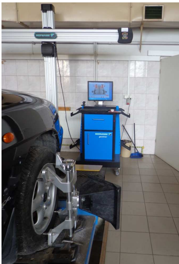
Fot. 2. Widok urządzenia do pomiaru i regulacji geometrii kół HOFFMAN Geoliner 650-3D
