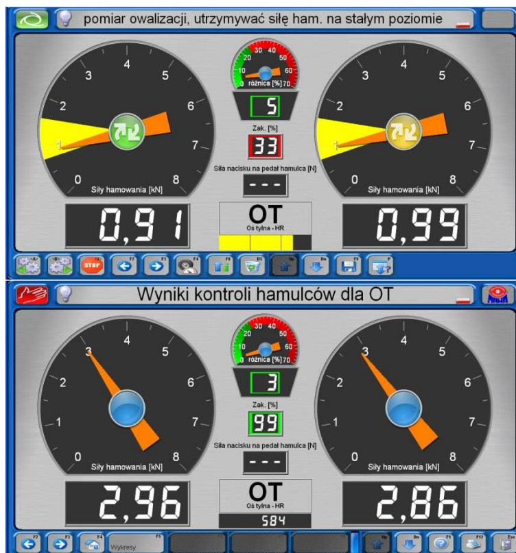
Rys. 8. Wyniki pomiarów skuteczności hamulców osi tylnej.
