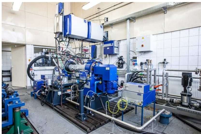
Fot. 2.1. Ogólny widok hamowni jednocylindrowego silnika badawczego firmy AVL
