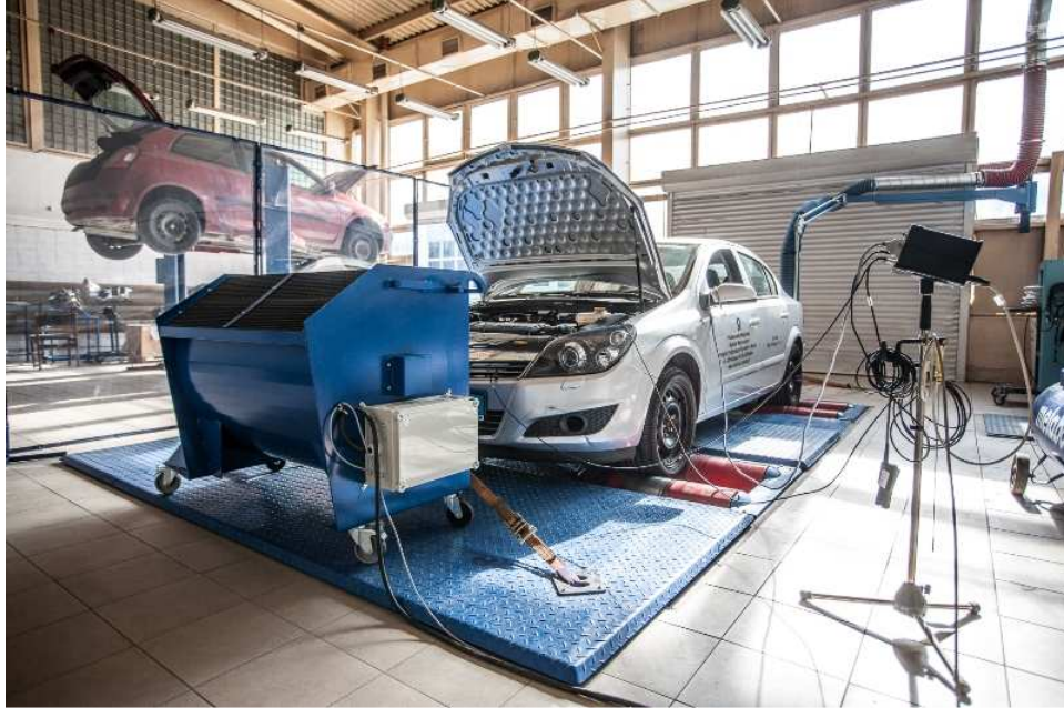
Fot. 1. Widok pojazdu na hamowni podwoziowej LPS-3000
