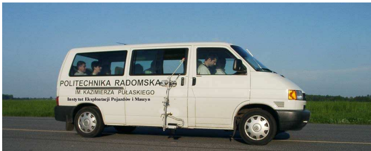
Fot. 3. Umieszczenie głowic pomiarowych rejestrujących podstawowe parametry ruchu pojazdu.
