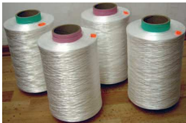
Rys. 2. Materiał badawczy w postaci nawojów polipropylenowego jedwabiu włókienniczego [opracowanie własne]
