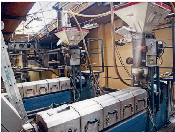
Rys. 4. Strefa dozowania i uplastyczniania mieszanki tworzywa
