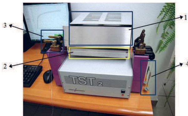
Rys. 7. Stanowisko do badania skurczu termicznego pod wpływem działania gorącego powietrza, w stanie naprężonym: 1 – komora ogrzewająca, 2 – badana przędza polipropylenowa, 3 – zaciski mocujące, 4 – obciążniki [10]
