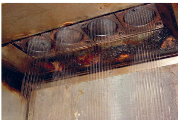
Rys. 5. Strefa przejścia uplastycznionych i zestalonych włókien przez otwory w dyskach przedziałniczych (filierach)
