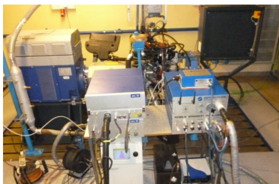
Rys. 4. Mobilne analizatory gazów wylotowych zainstalowane na stanowisku badawczym: od lewej AVL MSS i SEMTECH DS
