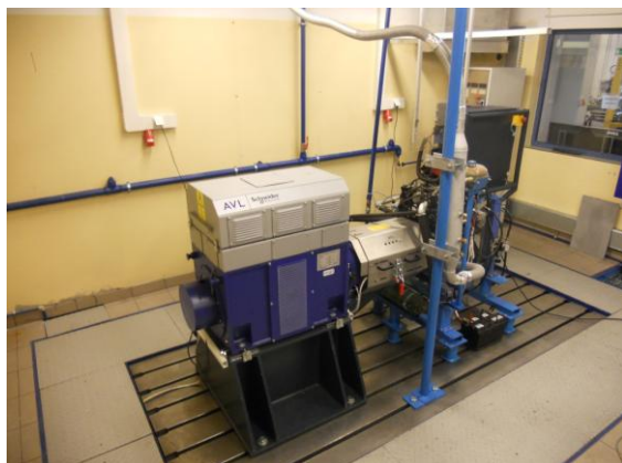
Rys. 1. Widok dynamicznego silnikowego stanowiska hamulcowego AVL DynoRoad 120 kW
