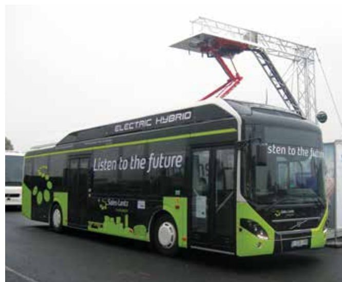
Volvo, oferując autobusy elektryczne, nie chce się ograniczać jedynie do sprzedaży samych pojazdów. W swoim portfolio oferuje całe systemy (włącznie ze stacjami ładowania Siemens, lokalizowanymi na końcówkach)
