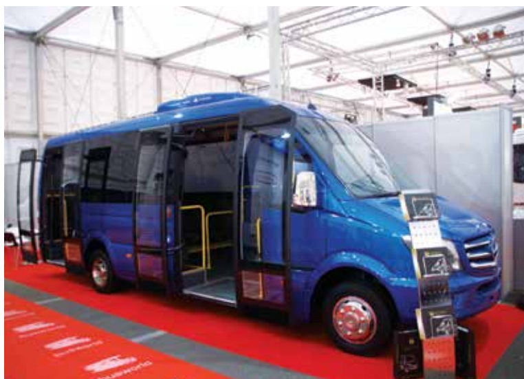
Turecki miejski minibus Tekaydinlar z dwójgim szerokich, bezstopniowych drzwi
