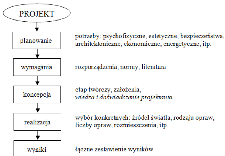
Rys. 2. Diagram kolejnych etapów projektowania oświetlenia z uwzględnieniem cech poszczególnych części
