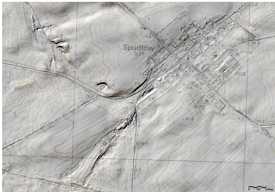
Rys. 15. Deformacje powierzchni terenu widoczne w lotniczym skaningu laserowym – obszar kopalni „Humboldt” (źródło: geoportal.gov.pl)
