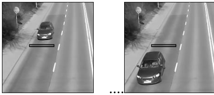
Rys. 3. Obrazy źródłowe z zaznaczonym polem detekcji
