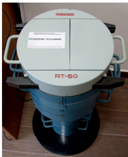
Rys. 1. Spektrometr RT-50 do pomiarów naturalnej promieniotwórczości gamma próbek skał Fig. 1. RT-50 spectrometer for natural gamma radioactivity measurements of rock samples
