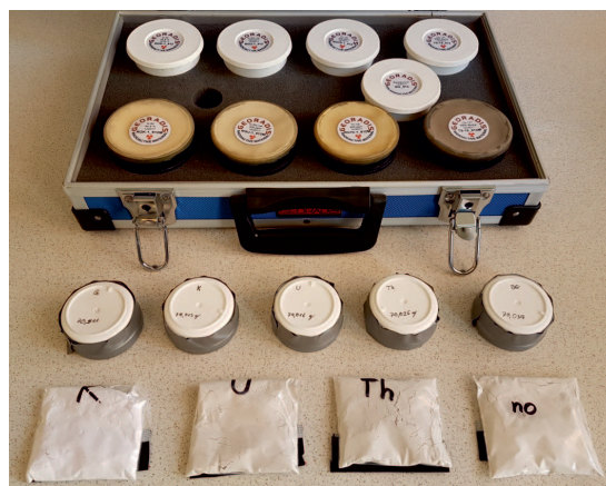
Rys. 2. Zestaw wzorców o masach 150 g, 70 g oraz 40 g wykorzystywanych do kalibracji aparatury RT-50 Fig. 2. A set of 150, 70 and 40 grams calibration standards used for RT-50 equipment
