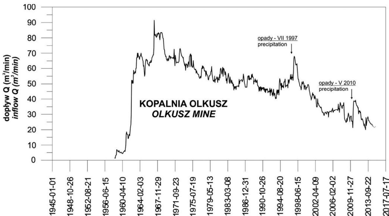
Rys. 6. Wykres dopływów do kopalni Olkusz w latach 1958 – 2015 Fig. 6. Inflows to the “Olkusz” mine in 1958-2015
