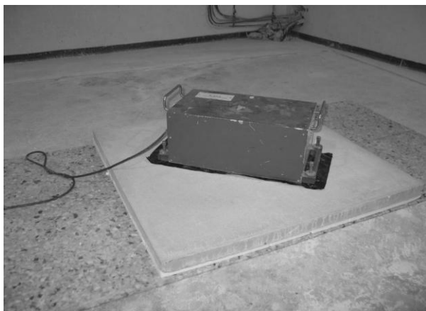
Rys.1. Fotografia przykładowej zmodyfikowanej podłogi pływającej (próbka nr 4). Na fotografii widoczny stukacz młotkowy.
