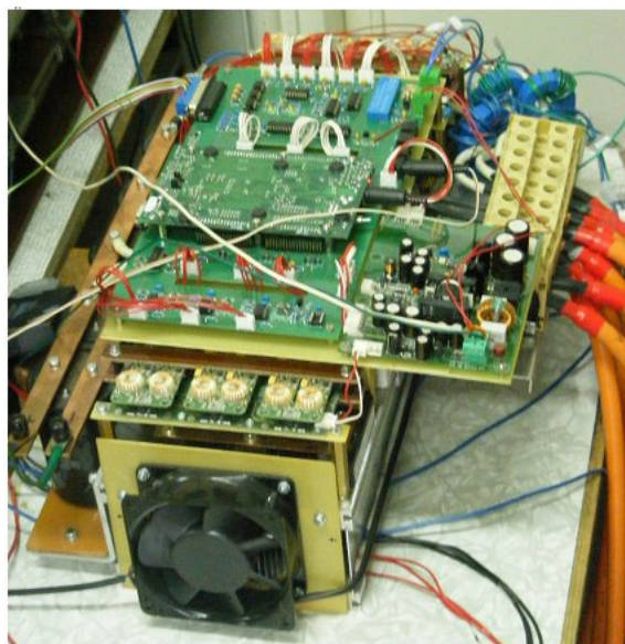
Rys. 3. Falownik silnika z zamontowanym układem mikrokontrolera sygnałowego (wersja laboratoryjna)
