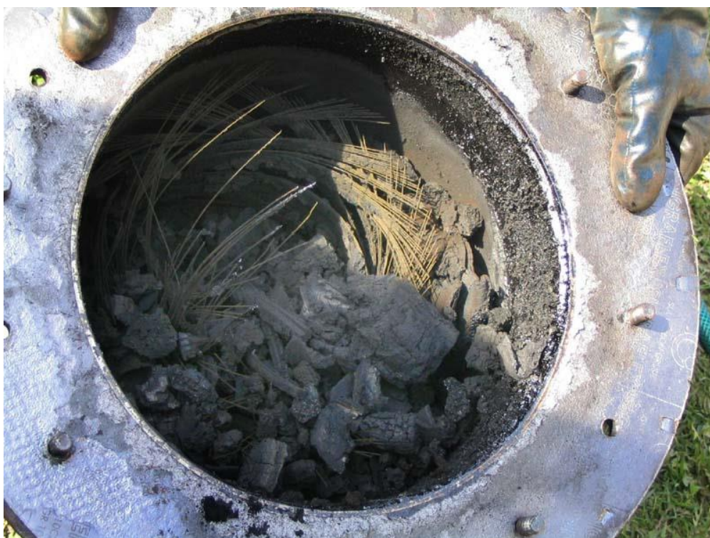
Rys.3.2 Widok komory reaktora ze stałą pozostałością podprocesową.(zdjęcie autora)
