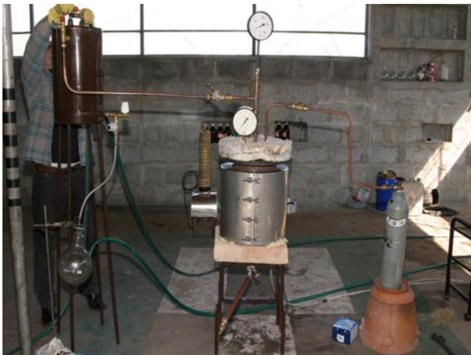
Rys. 3.1 Widok stanowiska badawczego instalacji przetwarzania organicznych odpadów gumowych w surowce. (zdjęcie autora)
