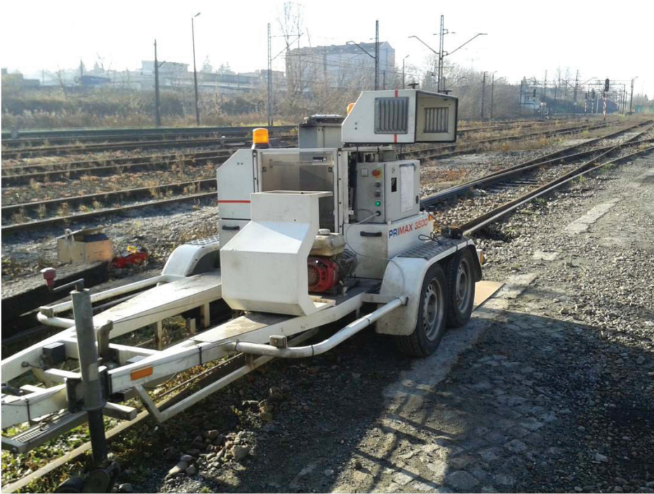
Rys. 4. Maszyna FWD-R podczas pracy na torze. Na widocznym etapie nie jest jeszcze wyposażona w koła kolejowe, stąd konieczność wjazdu na tor po prowizorycznie przygotowanej rampie
