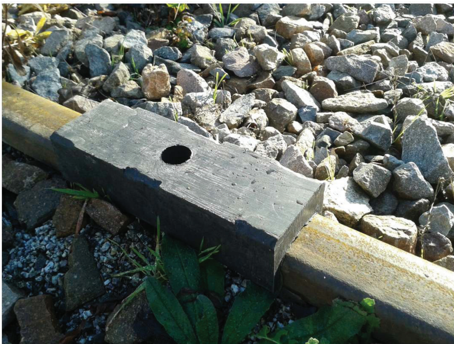
Rys. 3. Przekładka stosowna na głowce szyny. Dobierane są parametry sztywności i tłumienia przekładek w celu sterowania impulsem siły. W środku przekładki widoczny otwór na czujnik prędkości szyny (geofon)
