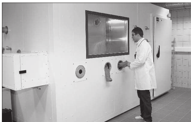
Fot. 8. Komora radonowa
