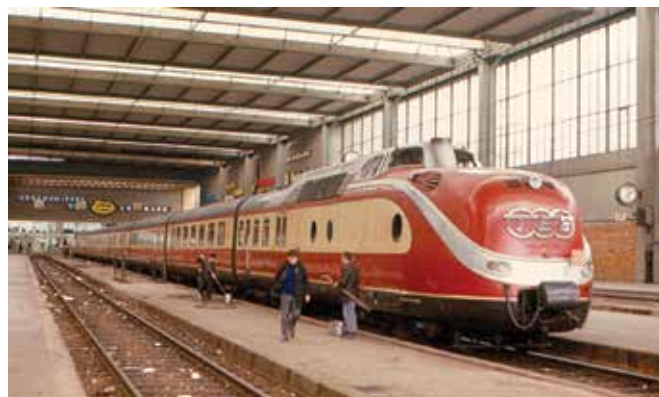
Rys. 3. Spalinowy zespół trakcyjny serii VT 11.5 kolei Deutsche Bundesbahn z 1957 r. jako „TEE” Monachium-Mediolan przez Brenner fot. Roger Wollstadt, 1970; WikiComm, Creative-Commons-Lizenz „Namensnennung – Weitergabe unter gleichen Bedingungen 2.0 generisch” (US-amerikanisch) lizenziert
