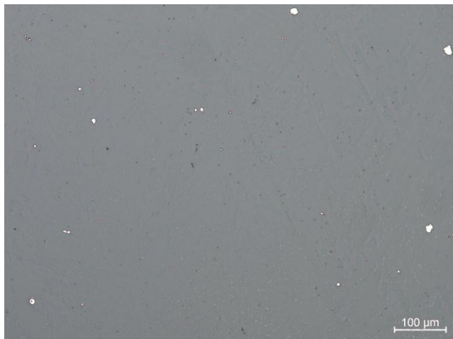
Rys. 2. Struktura staliwa - oznaczone porowatości Fig. 2. Cast steel microstructure with marked porosity
