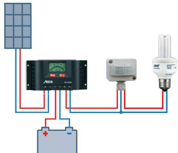
Rys. 11. Układ połączeń inwertera wyspowego [16]
