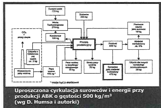
Rys. 5. Uproszczona cyrkulacja surowca i energii przy produkcji autoklawizowanego betonu komórkowego o gęstości w stanie suchym 500 \text{ kg/m}^3 (wg D. Humsa [19] i G. Zapotocznej-Sytek [2, 20])
