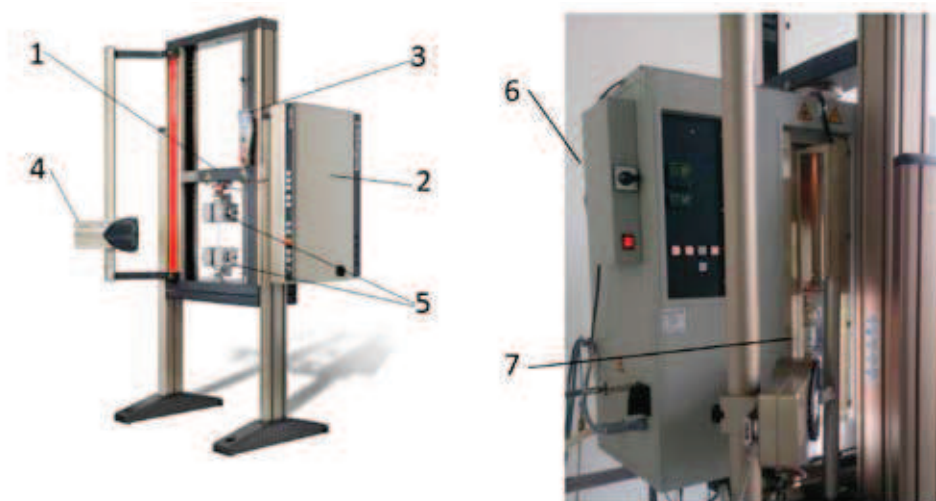
Rys. 4. Wygląd maszyny wytrzymałościowej Zwick/Roell Z010: 1 – rama obciążeniowa, 2 – sterownik, 3 – manipulator, 4 – video ekstensometr, 5 – uchwyty do próbek, 6 – komora, 7 – zamocowana próbka Źródło: materiały reklamowe Zwick Roell [4]
