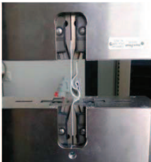
Rys. 2. Wygląd zamocowania próbki badawczej w uchwytach maszyny wytrzymałościowej.
