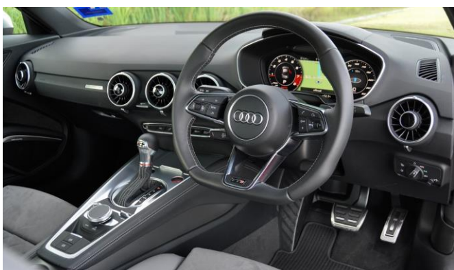
Rys. 10. Wirtualny kokpit w samochodzie Audi z widocznym na tle kierownicy wyświetlaczem ciekłokrystalicznym [17]
