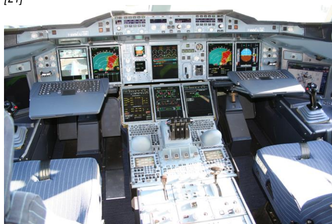
Rys. 17. Kokpit w samolocie Airbus A380 z widocznymi na wprost ośmioma wyświetlaczami ciekłokrystalicznymi [21]
