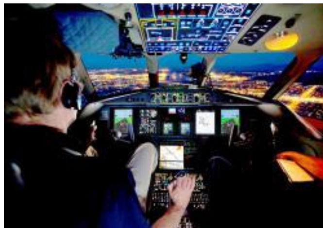
Rys. 16. Opracowana przez firmę Jet Aviation ciekłokrystaliczna awionika (widoczna na wprost pilota) dla samolotu Falcon i Cessna [21]
