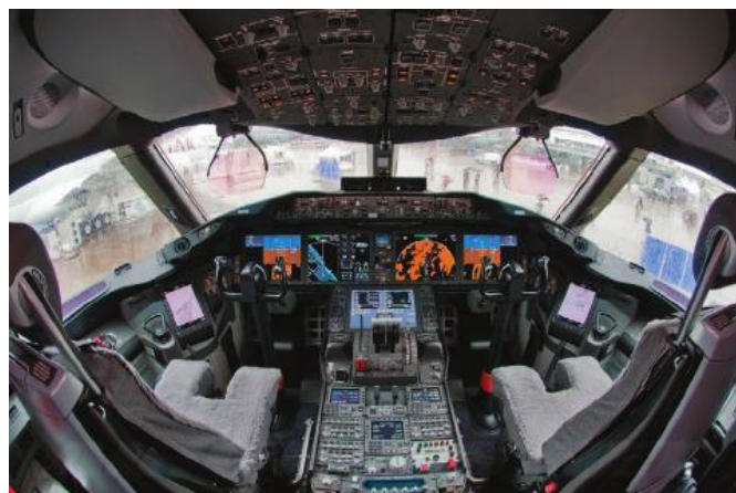
Rys. 18. Kokpit w samolocie Boeing 787 Dreamliner. Nad siedzeniami pilotów widoczny system HUD [22]
