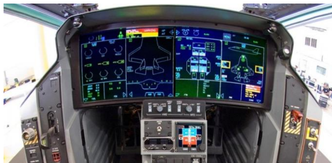
Rys. 15. Wielkopowierzchniowy wyświetlacz ciekłokrystaliczny (LAAD - Large Area Avionics Display) przeznaczony dla samolotu F-35 (na zdjęciu w kolorze fioletowo-zielonym)[20]
