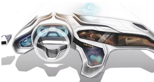
Rys. 13. Przewidywany wygląd deski rozdzielczej samochodu zaprojektowanej z wykorzystaniem wyświetlaczy ciekłokrystalicznych o dowolnym kształcie [18]
