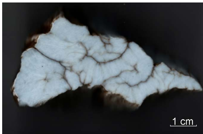
Ryc. 8. Struktura „trzewiowa” anhydrytu i ilaste laminki (ciemne) w anhydrycie (jasny)
