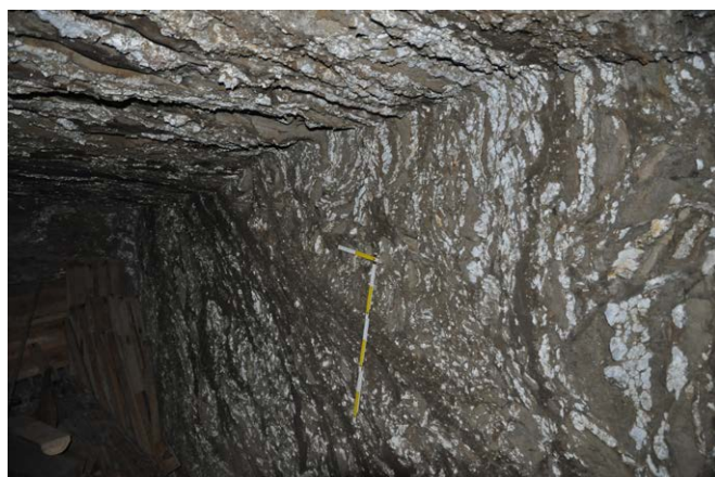
Ryc. 5. Skupienia anhydrytu w ostatniej warstwie Poprzecznika 1 Fig. 5. Anhydrite aggregates in the last layer in Crosscut 1
