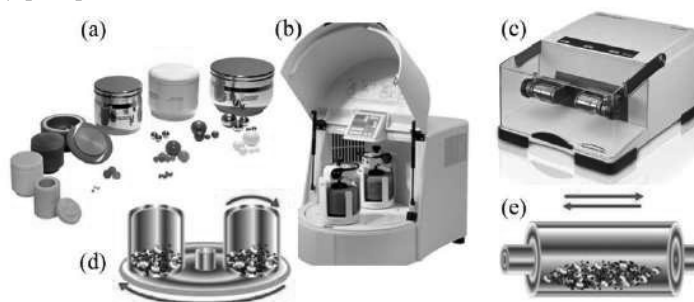
Rysunek 2. Zdjęcia przedstawiające: (a) akcesoria do planetarnego młynka kulowego, (b) planetarny młynek kulowy, (c) planetarny młynek wibracyjny, (d) schemat działania planetarnego młynka kulowego oraz (e) schemat działania młynka wibracyjnego [9]. Rysunek wykonany na podstawie pracy [9] za zezwoleniem. Prawa autorskie © 2013, należą do Royal Society of Chemistry
