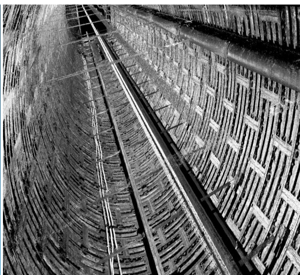
Rys 2. Widok rury szybowej reprezentowanej przez chmurę punktów z pomiaru z użyciem Mobilnej Platformy Górniczej (Adamek et al. , 2014)
