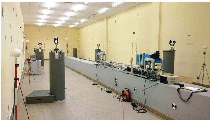
Rys 4. Pole kalibracyjne Mobilnej Platformy Górniczej (MPG) (SKALA 3D, 2011-2014)
