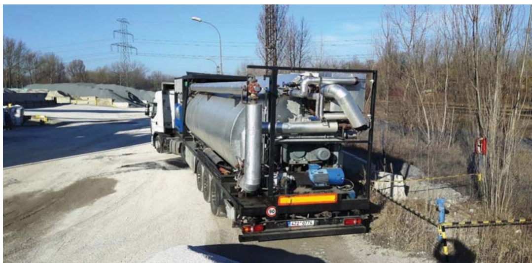
Fot. 8. Urządzenie do modyfikacji asfaltu gumą (zdjęcie Oddział GDDKiA Kraków)
