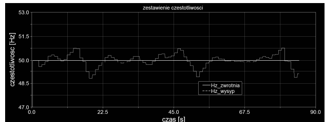
Rys.13. Przebieg zmian częstotliwości napięcia zasilania silników napędu dla symulacji C [4]
