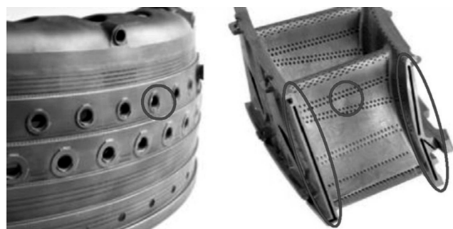
Rys. 2. Elementy turbiny z otworami chłodzącymi [8]
